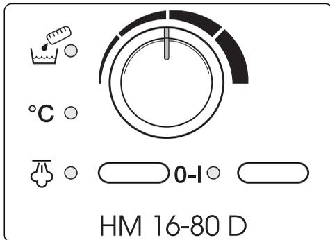
Die Mangel wird mit dem Schalter **I-O** ein- und ausgeschaltet.
