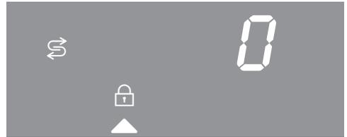
Danach ist die Verwendung der Betriebsart Klimagaren [☉] gesperrt. Sie ist erst wieder möglich, wenn Sie den Entkalkungsvorgang durchgeführt haben.
